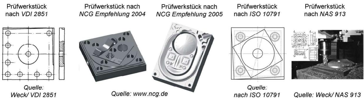
Bild 1.63 Beispiele für Standard-Prüfwerkstücke
