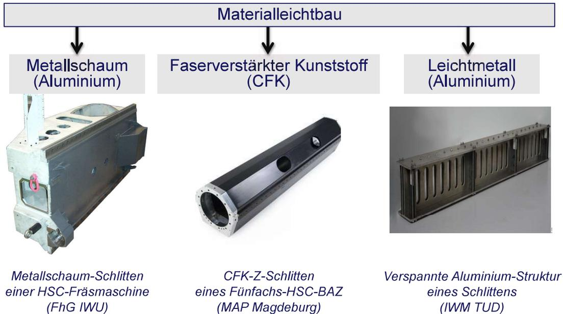
Bild 1.33 Beispiele für den Materialleichtbau an Werkzeugmaschinen
