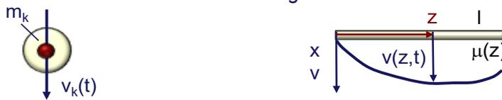
Bild 2.243 Ersetzende Punktmassen für kontinuierlich verteilte Trägheiten
