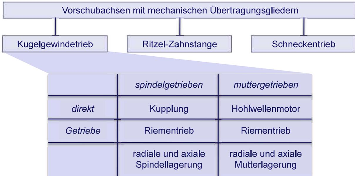
Bild 6.26 Varianten des Kugelgewindetrieb
