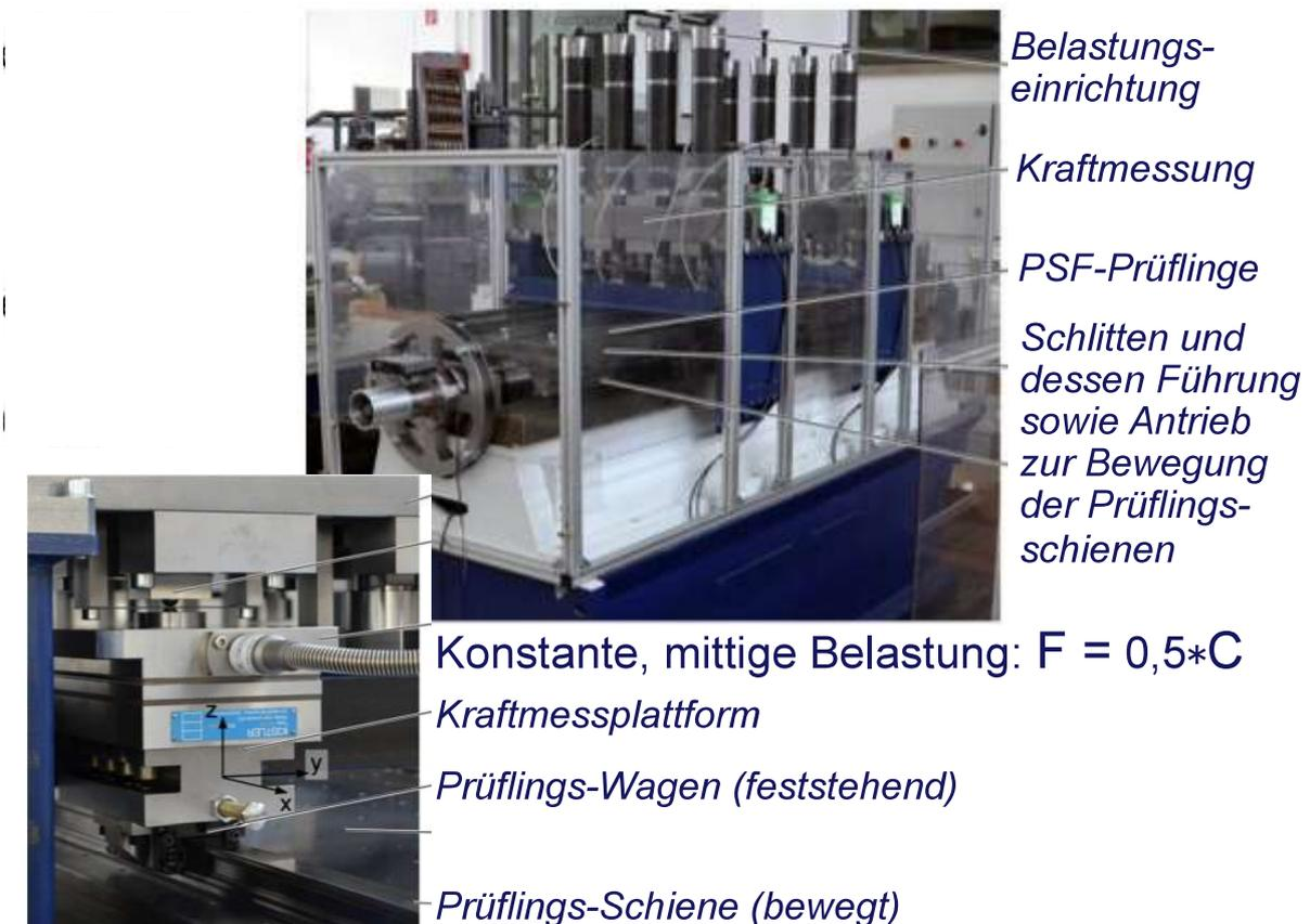
Bild 6.73 Profilschienenführung – Dynamische Tragzahl
