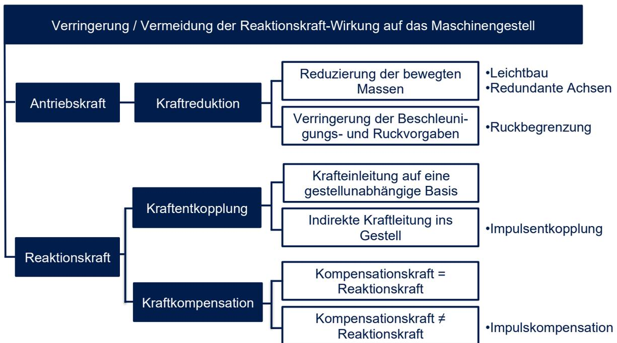
Bild 6.23 Möglichkeiten zur Reduzierung der Schwingungsanregung
