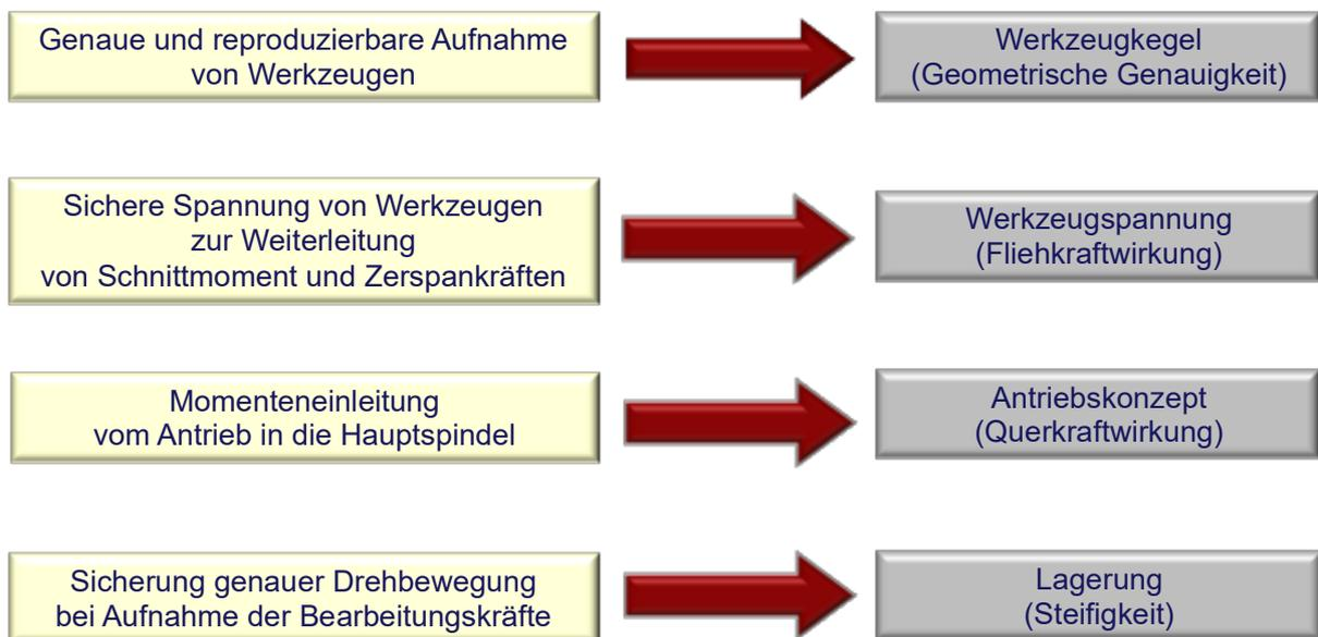
Bild 5.24 Anforderungen an Hauptspindeln und Lösungen
