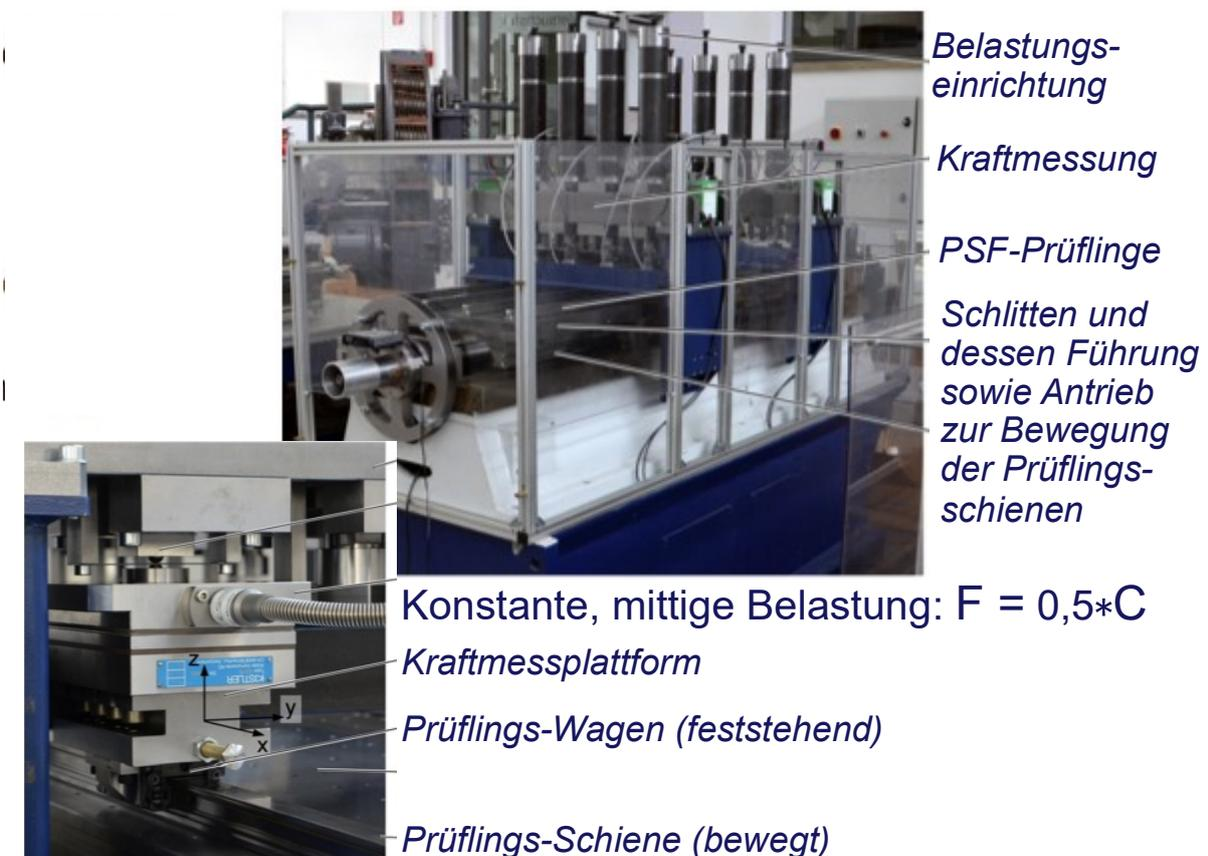
Bild 6.73 Profilschienenführung – Dynamische Tragzahl
