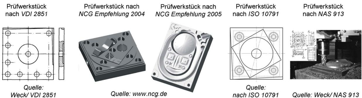
Bild 1.63 Beispiele für Standard-Prüfwerkstücke
