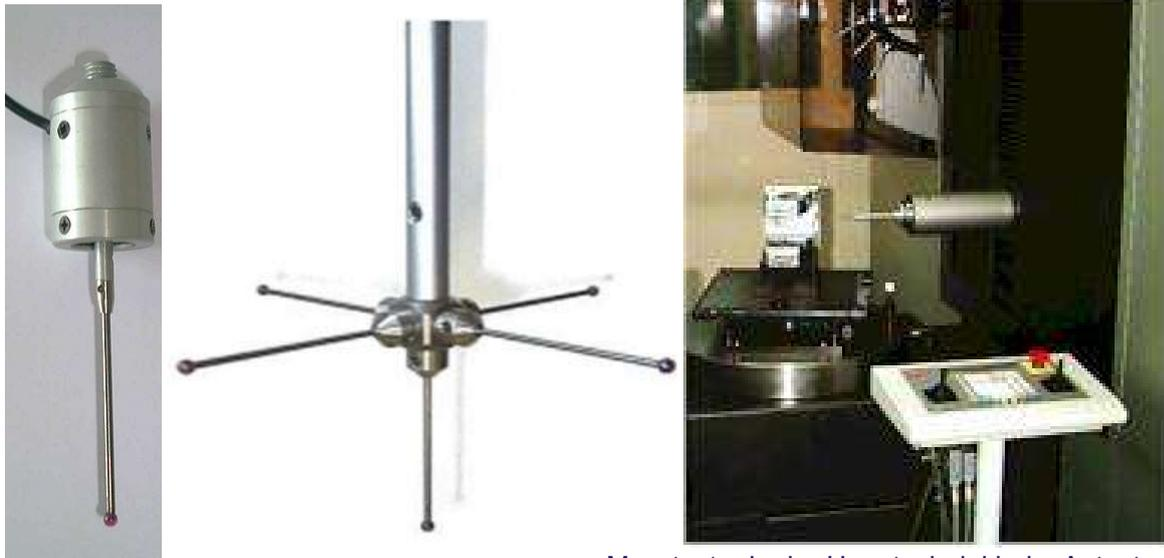
Messtaster in der Hauptspindel beim Antasten eines Werkstückes auf dem Maschinentisch
