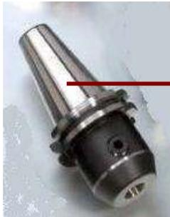
genaue und reproduzierbare Lage von WZ zu Drehachse (Referenzierung)
